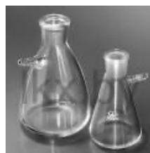
Применяется вместе с воронкой Бюхнера и соответствующей пробкой для фильтрования в методиках с аспирацией. Изготовлена из термостойкого боросиликатного стекла. Воронка и пробка приобретаются отдельно.
