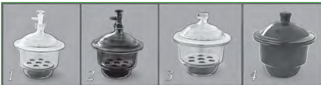
Разработаны для создания разреженной атмосферы в объеме сосуда. Предназначены для высушивания и хранения гигроскопичных веществ. В комплект входит керамическая вставка. Изготовлены из химико-лабораторного стекла.
